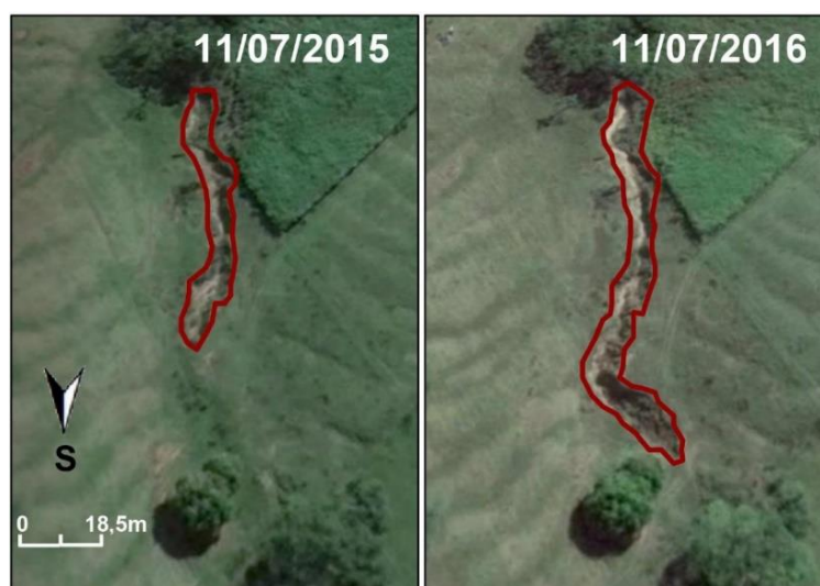
Figura 3. Expansão da voçoroca entre os anos de 2015 e 2016
