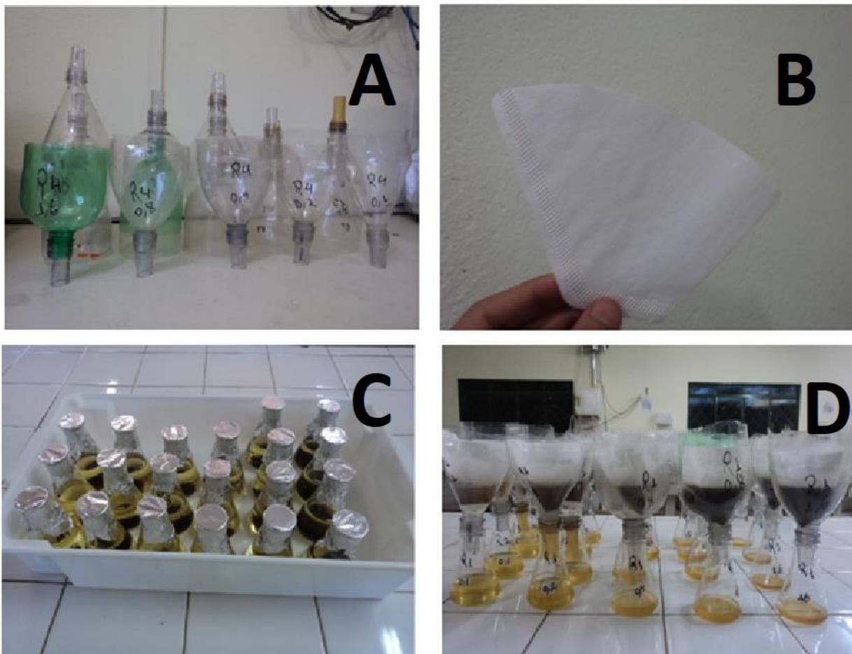
Figura 4. Imagens das etapas de desenvolvimento da pesquisa. A – Funis e garrafas pet utilizadas no experimento. B – Filtro de papel para filtragem das amostras. C – Biossorventes submetidos ao processo de adsorção. D – Biossorventes sendo filtrados para determinação das quantidades retidas nas amostras.
