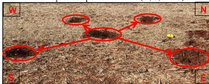
Figura 2: Amostragem composta por cinco subamostras: uma amostra central e outras nas direções dos pontos cardeais (N, S, L e O).
