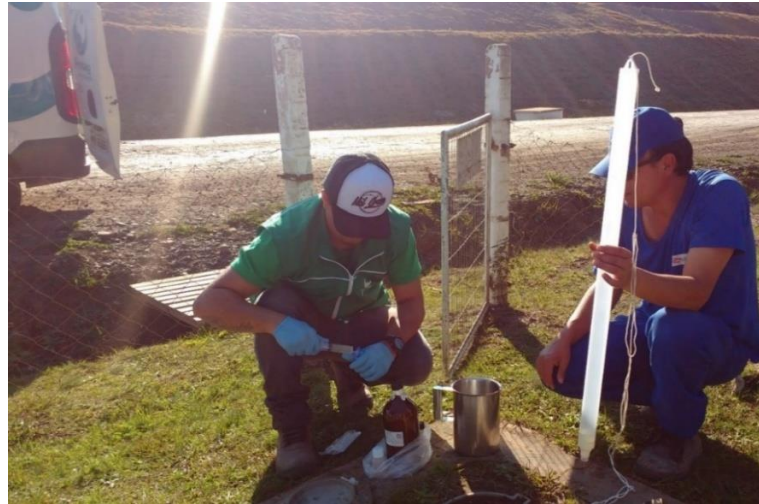
Figura 4 - Coleta de água subterrânea segundo o Standard Methods.
